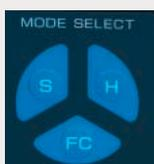
キビキビとした操作感覚のHモード、滑らかな操作感覚のSモード(初期設定)、ソフトな操作に最適なFCモード。スイッチひとつで切替られます。
