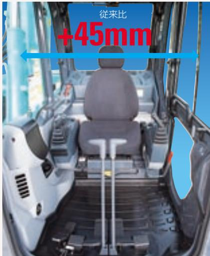
中大型通常形モデルに搭載したキャブと同じ幅と高さを実現したビッグキャブを搭載。オペレータ前方にスペースを確保してゆとりある操作空間を実現。フロアも広く足元も快適です。
