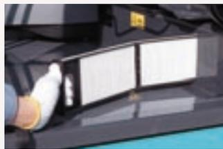
●工具なしで取り外せるエアコンフィルタ(内気/外気とも)。
