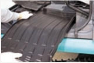
●外しやすい分割式の耳つきフロアマット。マットの下にはフロア排水口を設置。
