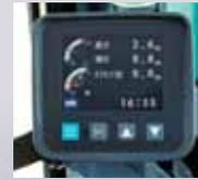
あらかじめバケットの高さと深さを記憶させれば、作業中もその位置で自動停止。接触回避などが容易になり、また一定深さで繰り返す溝掘削などの効率アップにも有効です。
