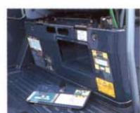
●外部ゲージで確認できる作動油タンクは、圧抜きブリーザ付き。
