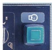
待機中など非稼働時にワンタッチでエンジン回転数を低減。ムダな燃料消費を抑え経済的、排ガス削減にも効果的。エネ革税制対象機にも指定されます。
