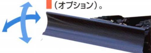
1本レバーで操作が簡単な油圧式バーチルトアングルドーザをオプション設定。片側排土や溝掘削での埋め戻し、不整地や傾斜路面での敷きならし作業が容易に行えます。
