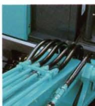
●ジョイント式で交換容易な各シリンダホース。ブーム背面は締めきりタイプの配管クランプがホースをきっちり固定、さらに前後方向のズレを防止。
