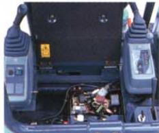
●シートを倒すだけで容易にリレーボックスの点検が可能。
