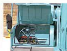
● バッテリー交換、液補充が容易な大型バッテリーボックス
