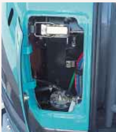
低い位置で燃料補給できる給油口
