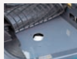
●キャブフロアマット下に設けたウォッシュ液タンク。
