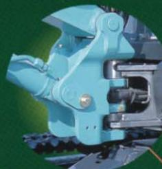
●断面が大きく変形しにくい鍛物製のアイドリングリンク。結合部のピンは開きを防止する拘束ピンで、偏摩耗を防ぐプレート付き。
