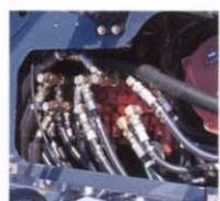
新型コントロールバルブはサービスバルブ付き。またアタッチメントには配管用タップドブロックを標準装備。各種解体用ニブラーや油圧プレーカーを装着する場合でも溶接工事やバルブ追加などの必要はなく、簡単に行えます。(ニブラー装着の場合は補強アームが必要です。)
