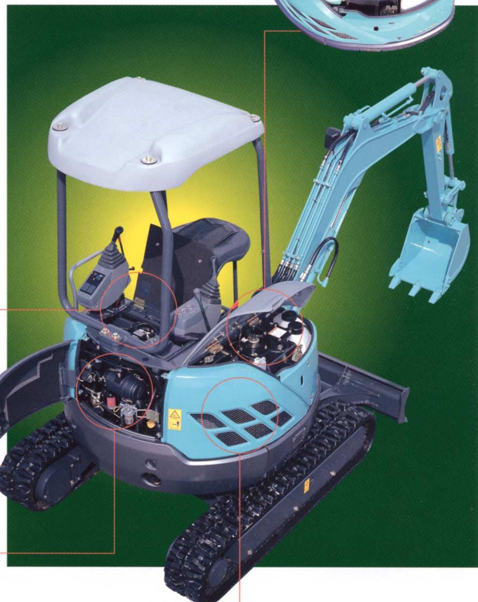
●外部ゲージで確認できる作動油タンクは、圧抜きブリーザ付き。
