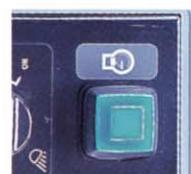
待機中など非稼働時にワンタッチでエンジン回転数を低減。ムダな燃料消費を抑え経済的、排ガス削減にも効果的。エネ革税制対象機にも指定されます。
