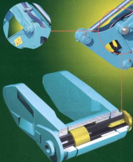
●スイングブラケット部は耐久性高い鍛物製。縦ピンは径をアップ、しかも上ピンは内側プレート固定タイプ。また、ブームフット、ブームシリンダ取付部には偏摩耗を防ぐプレート付きピンを採用。
