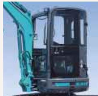
万一の転倒時にもオペレータが身体を支柱に預けられる3柱タイプ。さらにTOPSの安全基準に適合した2柱タイプもオプション設定。
