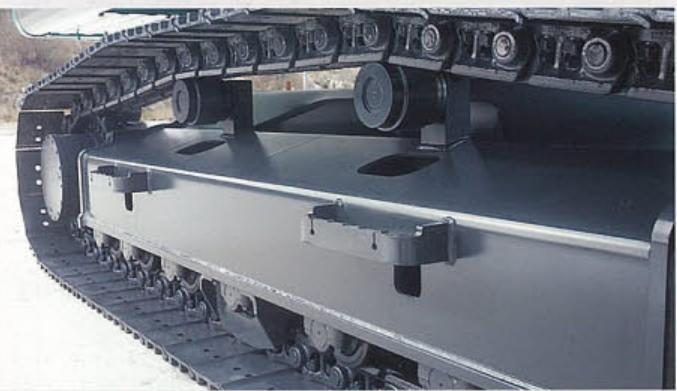
●泥落ちしやすい片流れ構造のクローラフレーム。
