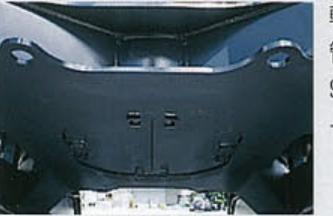
転石や鉄筋類などで足回りの配管等を損傷しないよう、厚さ9mmの鉄製カバーでロアフレームを密閉化。
