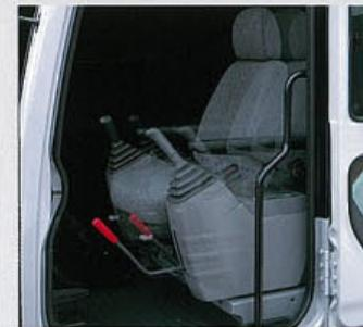
座面角度や高さも変えられるチルト機能付きシートを採用。シートだけとシート/コントロールボックス一体のダブルスライド調整が可能です。
