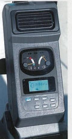
各種スイッチ機能を集約した新型マルチディスプレイ。ゲージ類は見やすいアナログ、液晶部はISO規定のマークと漢字・ひらがなとの組み合わせで情報表示。マシンコンディションの常時把握とトラブルの早期発見、迅速対応を促します。
