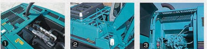
①高温部との接触を防ぐサーマルガード。②マシン上部に乗り降りしやすいハンドレール(欧洲規格適合)。③エンジン、マフラーへの作動油飛散を防ぐ遮熱プレート。
