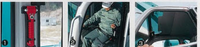
①緊急脱出用のライフハンマー②ホールド性優れたリトラクタブルシートベルト③眩しい陽射しを遮断するサンバイザ●夜間作業時に役立つドア連動ルームライト。
