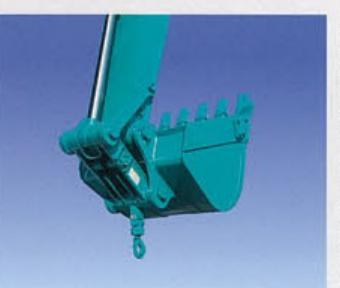
クレーン構造規格をクリア。信頼高い圧検式で荷重はディスプレイ表示。荷振れが小さいリンク直結式フックで、掘削作業時にはフックをリンク内に収納するだけでOK。クレーン作業時には安全操作をアシスト(Aモード)します。
