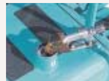
●自動給油にも対応できる大型燃料給油口。
