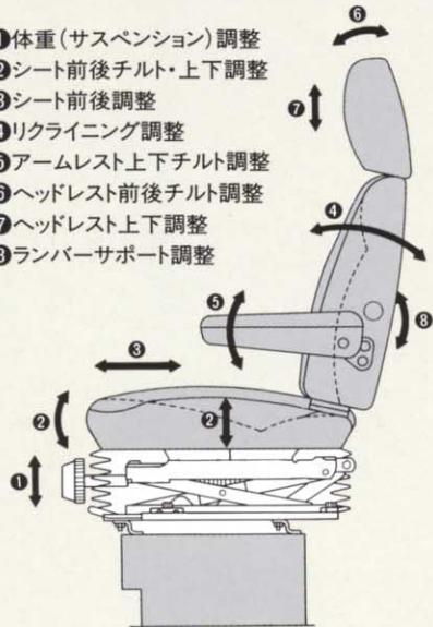
作業状況によって最適ポジションが選択できる「ダブルスライド」方式を採用。オペレータとコントロールボードの位置関係を変更できるシートだけのスライドと、深掘り時など作業状態によって操作ポジションを調整できるコントロールボード/シート一体のスライドが可能です。
