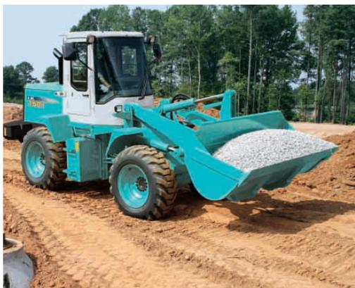
コモンレール式超高压燃料噴射エンジンを採用。クラストップの高いエンジン出力を発揮。さらに最大トルクを従来機に比べて約7%アップ。発進/停止を繰り返す作業も力強い加速力でスムーズに行えます。
