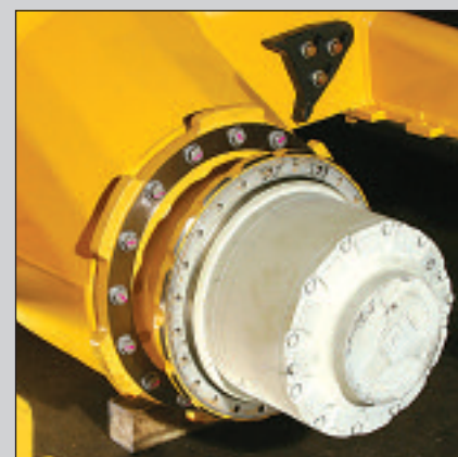
ホイール内部に配置される駆動モータ
