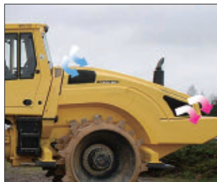
エンジン前方の高い位置にエア吸入口を設置。粉塵の流入を防ぎます
