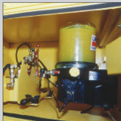
自動給脂システムにより、適切な給脂が自動的に
