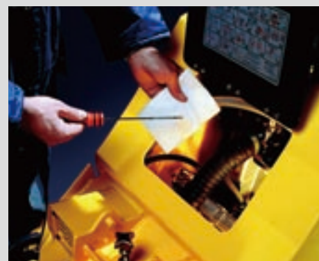
メンテナンスハッチによりすべての日常メンテナンスが可能。フード開閉の必要がありません。
