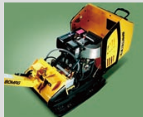
フルカバーフードは最低限のボルト着脱でフルオープンが可能
