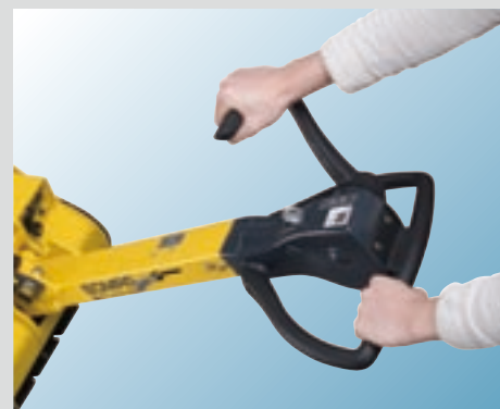
油圧駆動によるトラベルレバーを装備。トラベルスピードの微調整が容易に行えます。
